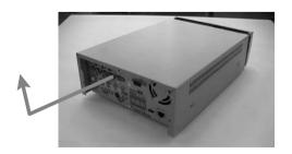
3. 背面にブラケットHDDがあります。ここにHDDを取り付けることができます。HDDを取り付ける ブラケットを留めているネジ (4箇所) を外します。
